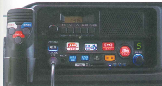
都路分署指令車のサイレンアンプ
